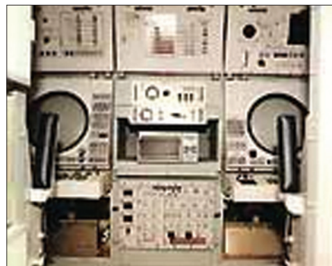
АРМ пункта управления огнем AN/MSQ-104
